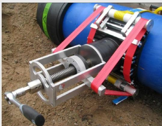
**Bild 10:** Aufspannung SA UNI mit dem Aufspanngerät UNITOP
