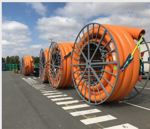
**Bild 1:** PE-Liner einbaufertig auf Trommel zum Transport
